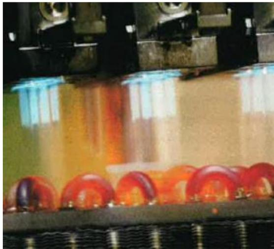
Машины пайки пламенем очень гибкие. Подходят так же для алюминиевых теплообменников, т.е. пайки алюминиевых калачей.
